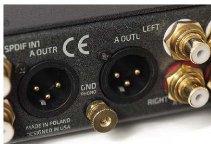
Począwszy od przetwornika C/A, tor sygnału jest zbalansowany, stąd wyjścia XLR nie są od parady.
